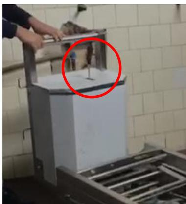
Para utilizar o carro pantográfico você pode elevar e descer o corpo de forma automática utilizando a alavanca.
